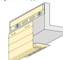
В карнизной доске + j делаются специальные отверстия с помощью пробойника, которые позволяют защелкнуть доску в финишную рейку.
