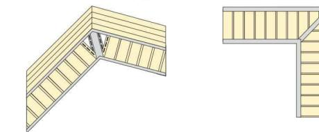
Сoffиты устанавливаются в зависимости от выбранных аксессуаров, или в J-профиль, или внутренний угол. Панели предварительно нарезаются на равные отрезки за вычетом зазора на установку.
