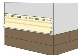
Стартовая рейка устанавливается при помощи уровня и фиксируется с помощью саморезов. Располагаем стартовую рейку пазами для крепления вверх и лицевой стороной (стиснением) наружу.
