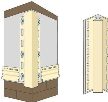
Наружные и внутренние углы устанавливаются на стыках стен. Обратите внимание, чтобы верхняя часть угла была ниже на 1-3 мм соffита или карниза, а нижняя часть ниже на 4-6 мм стартовой рейки.
